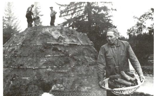
Kolfatet ble brukt til å bære kol fra mila til lagringsplassen. Fordi det var så lite, var det lettere å oppdage kolbiter med glør i. Foto: Skogmuseet
